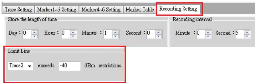
在勾选‘Open the send mail function’复选框前请先填写如下表格。设置好测量触发条件和限制线后，SpectrumShot 将自动发送邮件给您。有两种方式发送邮件：‘Single’ 和 ‘Repeat’。‘Repeat’ 发送方式意味着你可以设置一个固定时间间隔来接收邮件（如每隔 10 分钟）。
