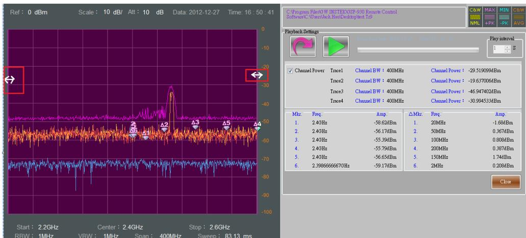
例如，下图是将'Channel BW' 设为'40MHz' 来测量'Trace 1~4'的'Channel Power'。
