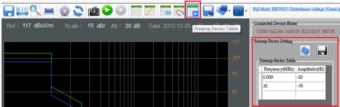
探棒，电缆损耗和前置放大器的设定值保存为\*.csv 格式, 这样就可以在 Microsoft Excel 中打开并编辑。
