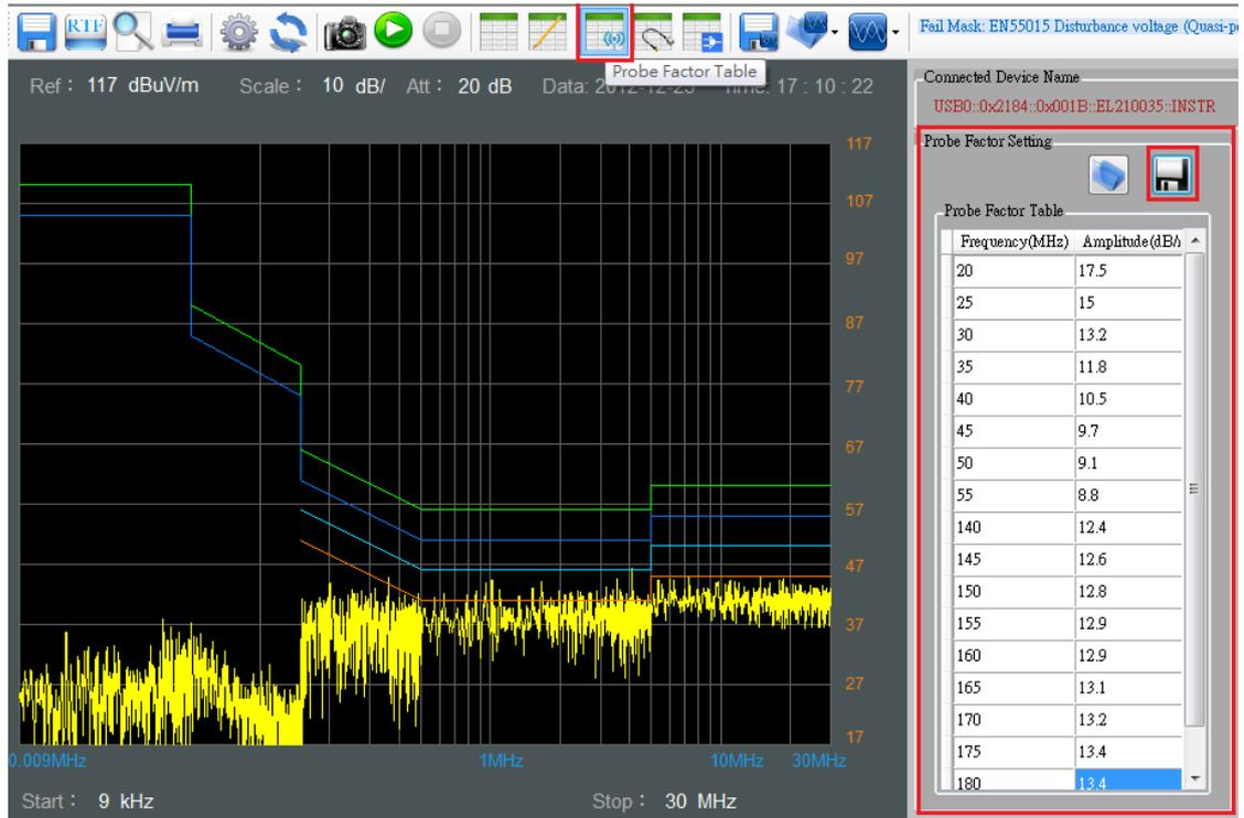
如果你知道电缆的插入损耗,LISN,或脉冲限幅器,它可以插入并存储在表列。
