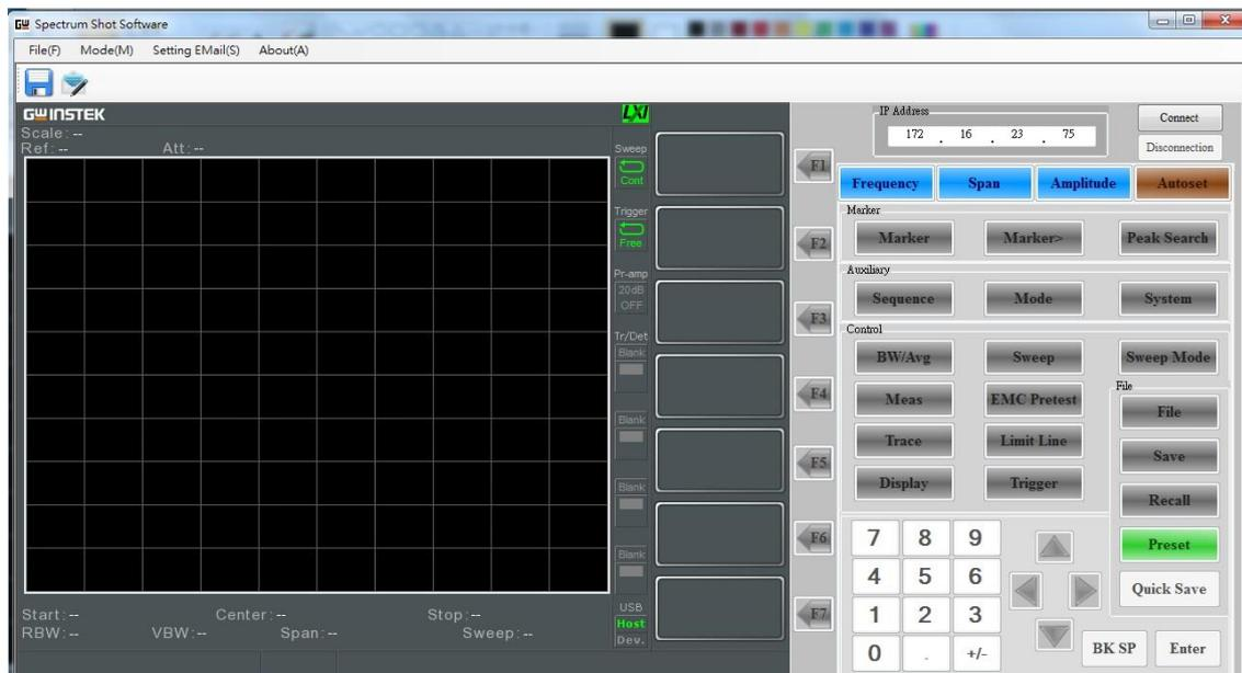
连接前，可以设置‘Setting Email’功能。勾选“Open the send email function”复选框填写一般账户信息。当测试结果匹配原始设置条件时，SpectrumShot 会自动发送一封电子邮件至指定地址。
