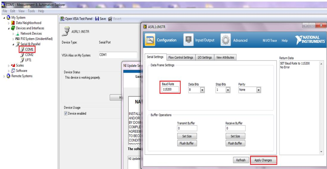
检查频谱分析仪的数据是否可读，可在 NI 488.2 的输入/输出设置和 \*IDN?\n 命令的执行处查看。
