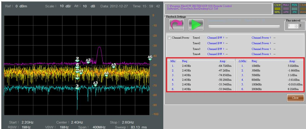
若想在测试结果内获得'Channel Power'，可勾选'Channel Power' 复选框。程序将显示表示带宽的紫色背景。可用鼠标在紫色背景处重新定义带宽。
