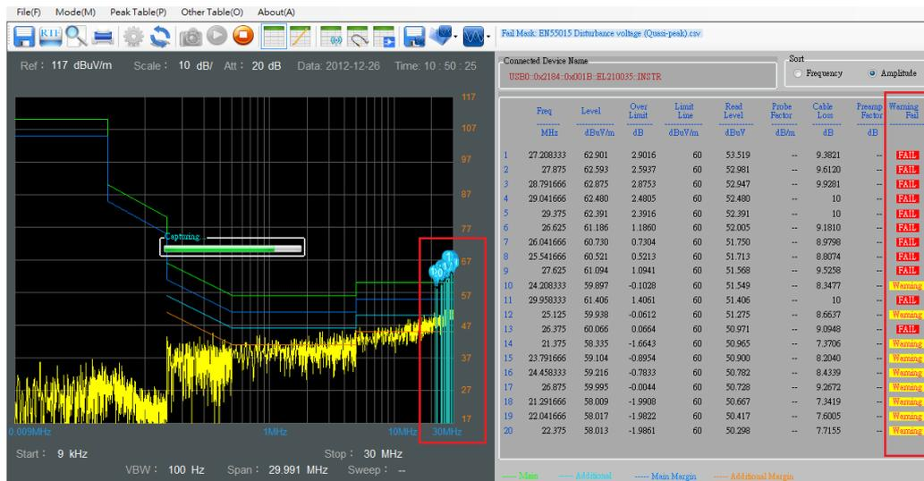
用户可自定义编辑峰值表功能中的峰值点。可直接用鼠标单击 SpectrumShot 测试结果或填写频率栏。具体可参考下图。
