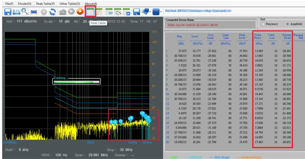
当频率点超过 Fail/Warning Mask, 屏幕将显示“Warning” 或 “Fail”。
