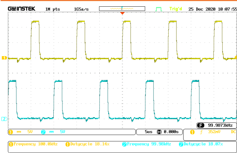
图 7.2 示波器测量的 PWM 占空比波形图
