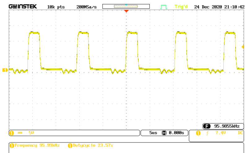
图 3.2 示波器测量的 PWM 驱动信号占空比波形图
